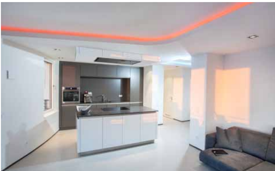
Lichtvouten mit LED-Beleuchtung in wechselnden Farben schaffen eine besondere Atmosphäre im Wohn- und Kochbereich.
