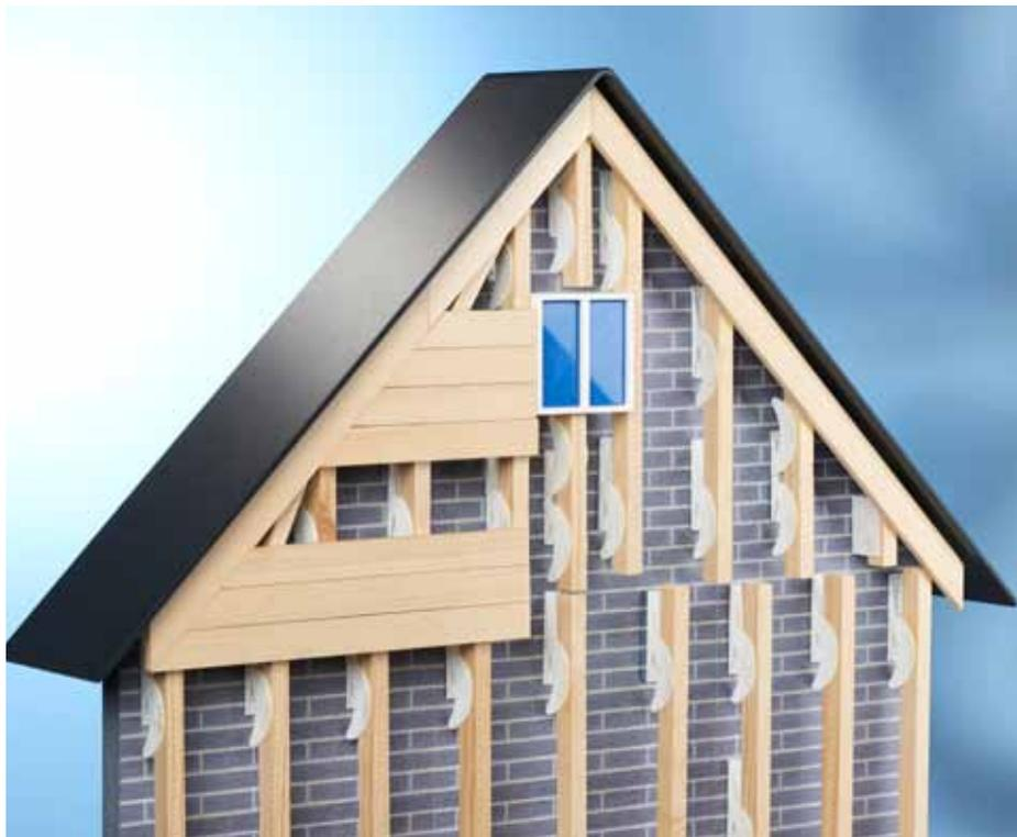
**Besonders im Bereich der Objektsanierung ist der Aufbau einer hinterlüfteten Fassade eine sehr energieeffiziente Maßnahme.**
