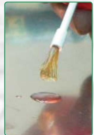
UNIGEL ist ein neuartiges Universal-Weichlöt-Flussmittel in Gelform zum Weichlöten von allen walzblanken Materialien (Kupfer-, Edelstahl- und Zinkblech) außer Alu.
