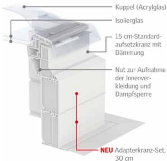
**Das VELUX Flachdach-Fenster für punktuelle Belichtung von oben ist flexibel einsetzbar. Mit dem neuen Adapterkranz-Set, bestehend aus zwei Adapterkränzen (ZCE), können Handwerker noch flexibler auf spezielle Einbausituationen reagieren und eine Gesamthöhe inkl. Flachdach-Fenster von 45 cm erreichen.**
